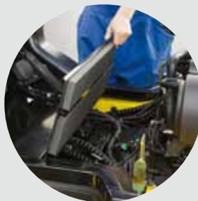
Einfach zu entfernende Bodenplatte (ohne Werkzeug)
