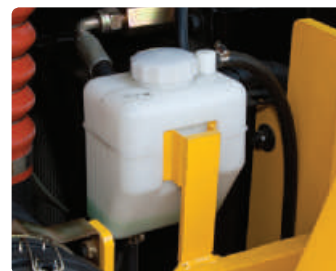
Ausgleichbehälter für Kühlflüssigkeit
